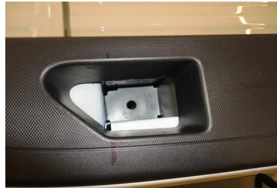
8. Coloque el bracket del lado conductor del pasamanos en el orificio del riel, de tal manera que las cuerdas del tornillo 3/8" atraviesen el barreno existente en la base del orificio. Introduzca la solera roscada por el orificio de la calavera y posicione la debajo del orificio del riel. Ver foto # 5 y 6
