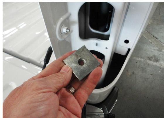
9. Alinee la solera roscada con el tornillo instalado previamente y atornille utilice un dado 9/16" con extensión para apretarlo. Ver foto # 7 y 8
