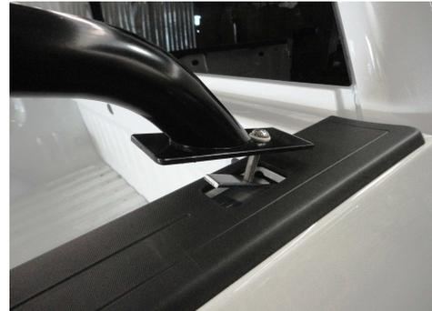
11. Coloque la solera roscada debajo del borde del orificio del riel y apriete manualmente. Sujete la otra solera del bed rail al bracket que coloco utilizando (1) tornillo 3/8" x 2" y rondana de nylon.
